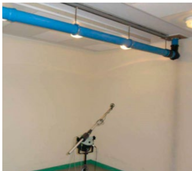
Fot. 6 Měření přímého hluku
